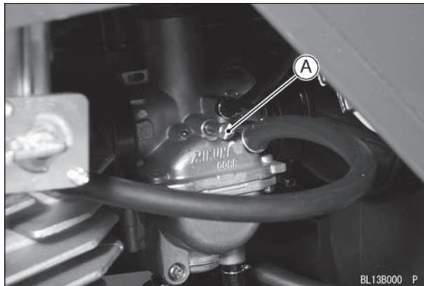
A. Винт регулировки оборотов холостого хода
